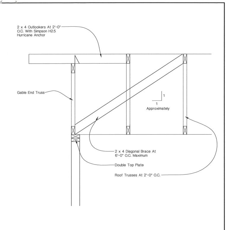
GABLE END TRUSS AT HINGE / TOP PLATE DETAIL
