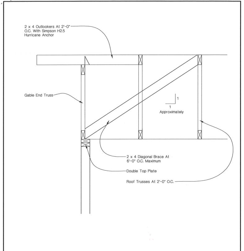
GABLE END TRUSS AT HINGE / TOP PLATE DETAIL
